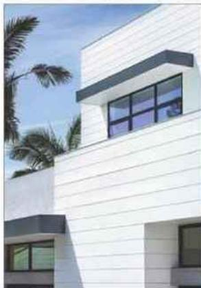
**Classement de réaction au feu : A2-s1, d0. Aspect : veinage bois ou lisse. Longueur : 3600 mm. Épaisseur : 11 mm. Largeur : 214 mm. Mise en œuvre : pose par emboîtement et vissage sur tasseaux, horizontale ou verticale, sans clip ni préperçage. Poids : 10,5 kg lame. Masse surfacique : 13,6 kg/m².**
